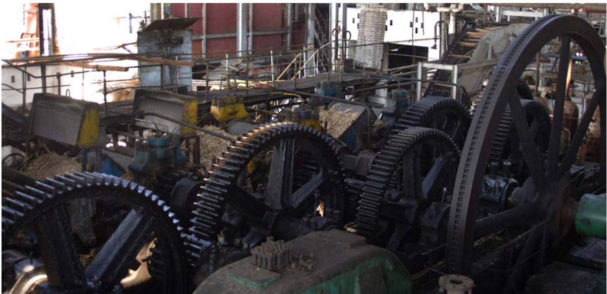
Räderwerk der mit Dampf angetriebenen Pressen
